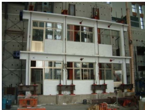
實尺寸校舍構架試驗
