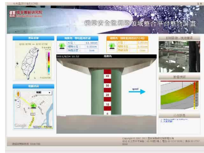
橋梁防救災手機即時監測與檢測影像平台 17
