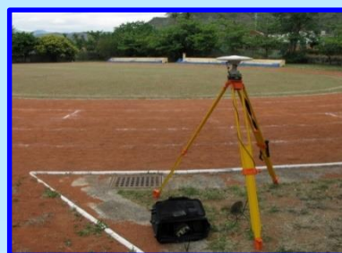
GNSS移動站測量
