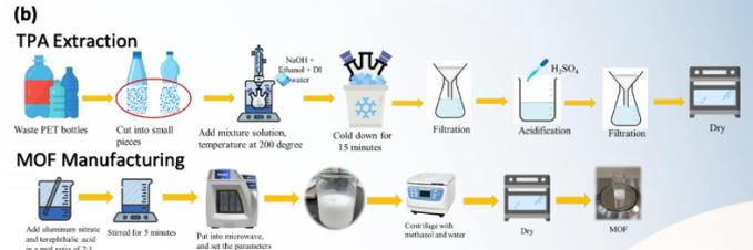
圖 2、( a ) 開發梯級吸附分離技術處理養豬廢水之相關參數；資料來源：(Chen et al., 2021)；( b ) 廢塑膠基吸附材料之解聚及金屬有機骨架之製備過程示意圖；相關成果已投稿至國際 SCI 期刊審查中。
