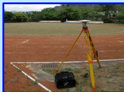
GNSS移動站測量
