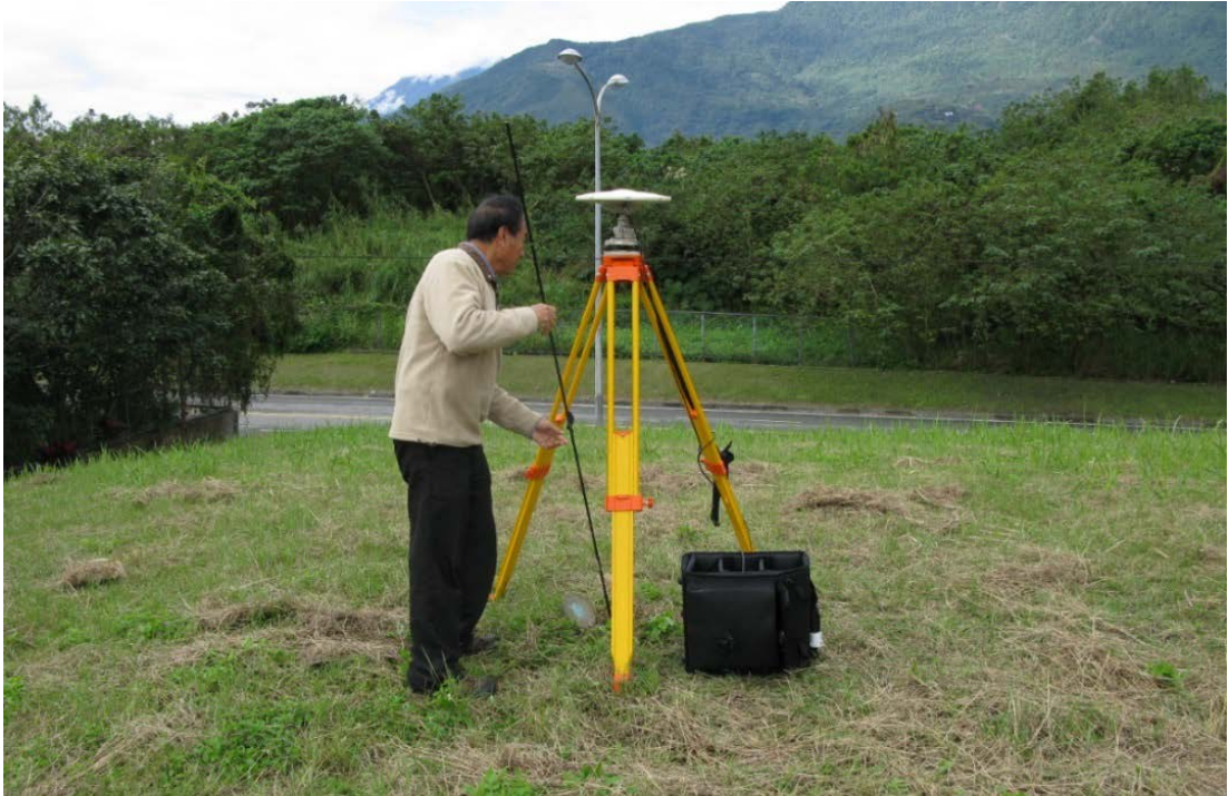
圖 3-3-2、本次地震後 GPS 移動站施測與檢測作業情形。觀測人員須使用量棒量測天線的斜高，以利將天線盤定位坐標換算至地面鋼標十字刻度位置，不同年度間的坐標變化可以顯示鋼標的位移情形。許晉瑋攝。
