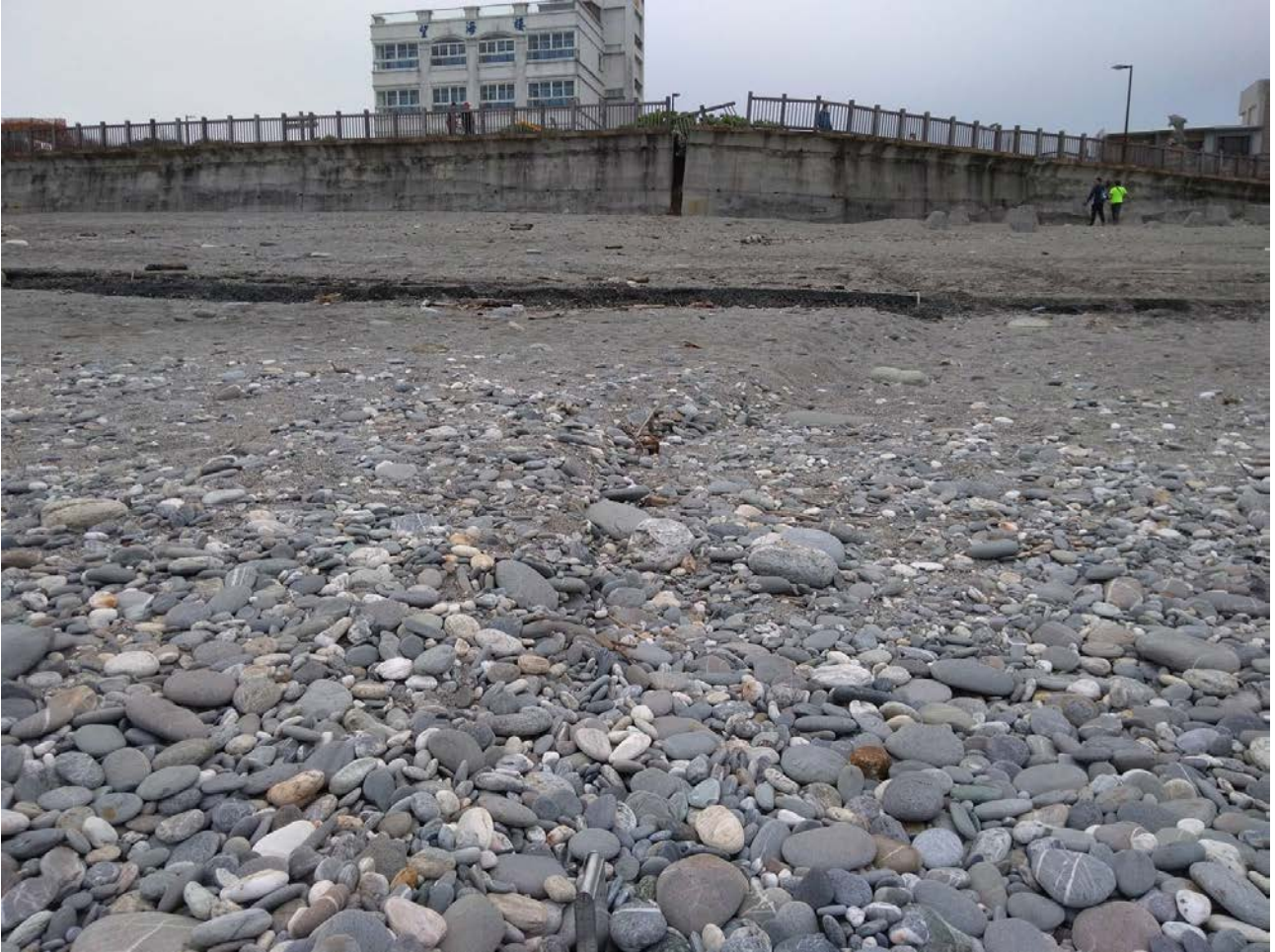
圖 2-1-1-2、七星潭南側砂礫灘之地表破裂。約朝 S50^{\circ}W 走向拍攝，變形現象顯示為兼具左移分量的逆衝斷層，東側抬升約 20 公分。照片後方出現另一道平行海岸，走向約為 S36^{\circ}E ，與其近乎正交，向南低角度傾斜的破裂（圖 2-1-1-3）。劉彥求攝。
