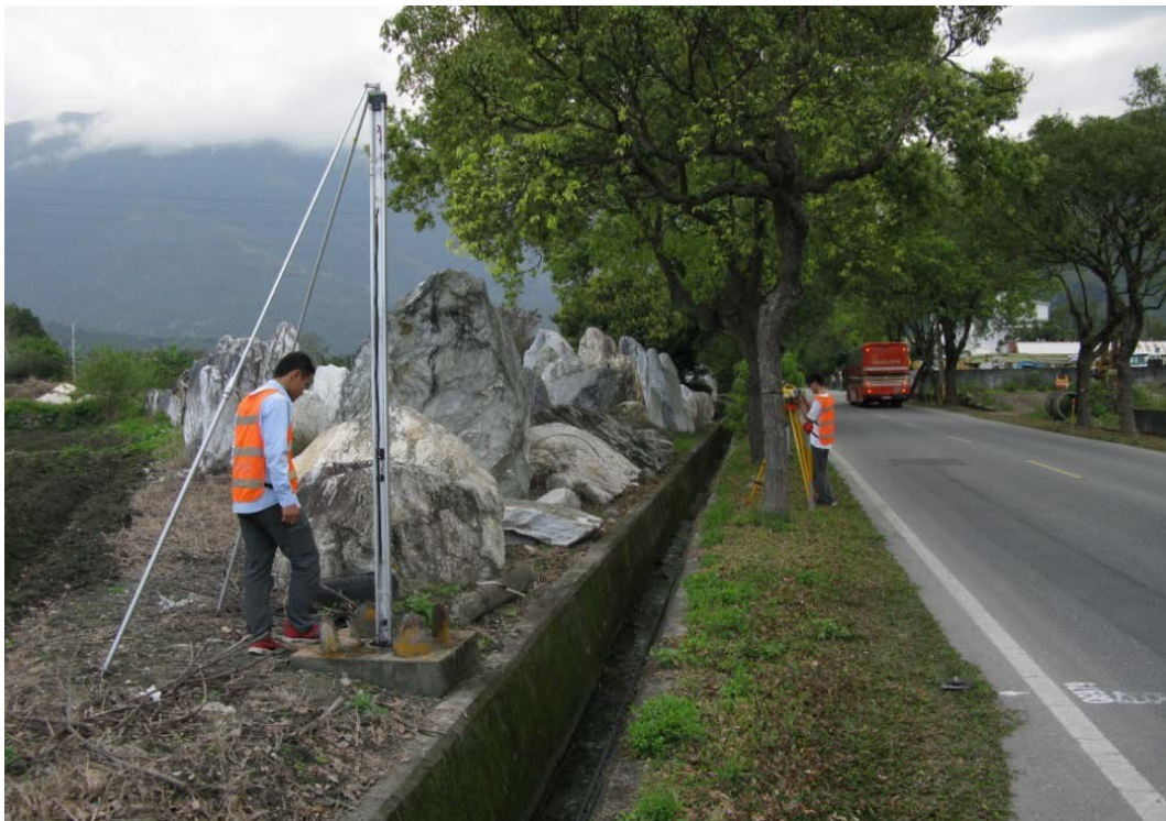
圖 3-4-3、嶺頂-龍澗測線精密水準測量情形。水準尺架設於水準點（點號：G979）上進行觀測作業情形。許晉瑋攝。
