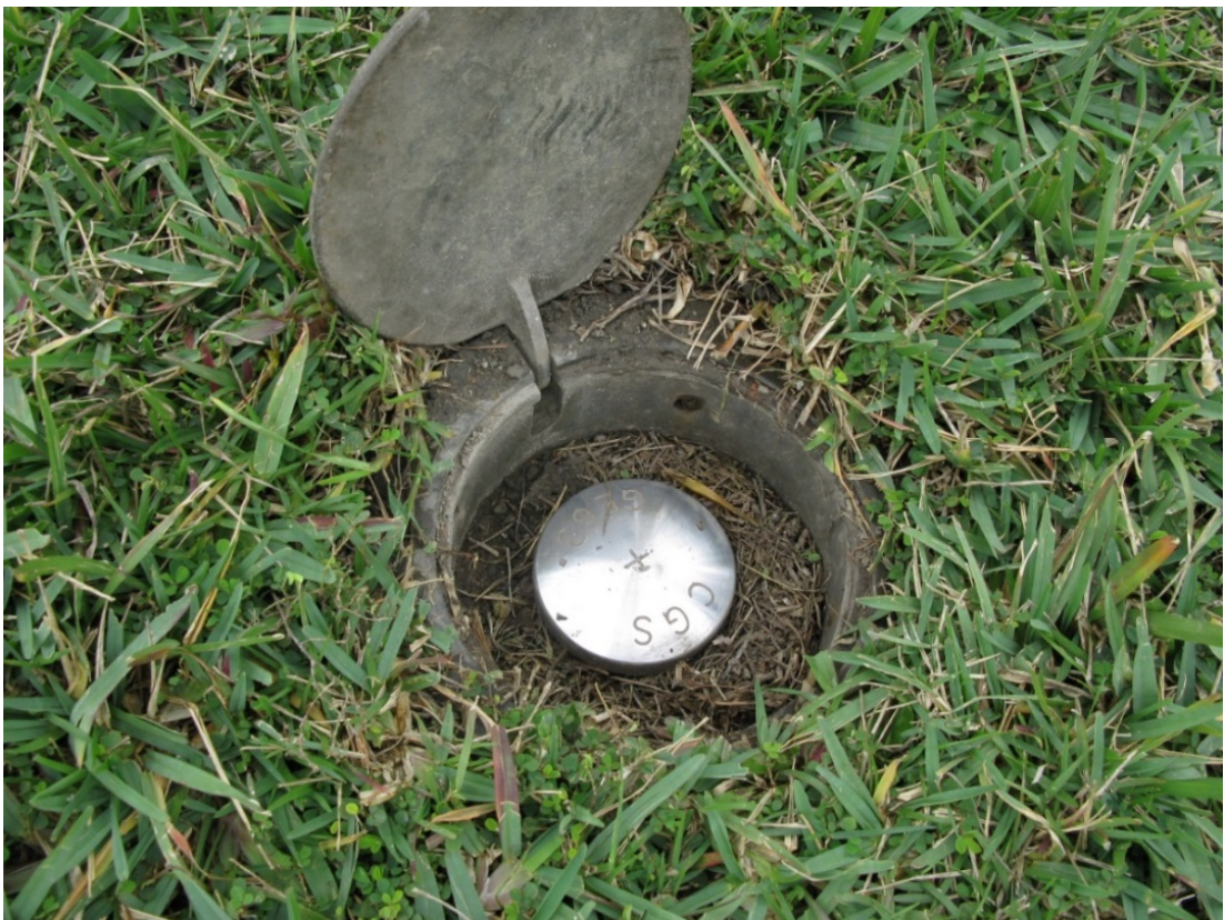
圖 3-3-3、本所活動斷層觀測網監測點照片。埋設於花蓮市復興國小操場的移動式 GPS 觀測點位（點號：GE63），鋼標上刻有十字刻度、點號及設置機關英文縮寫。許晉瑋攝。
