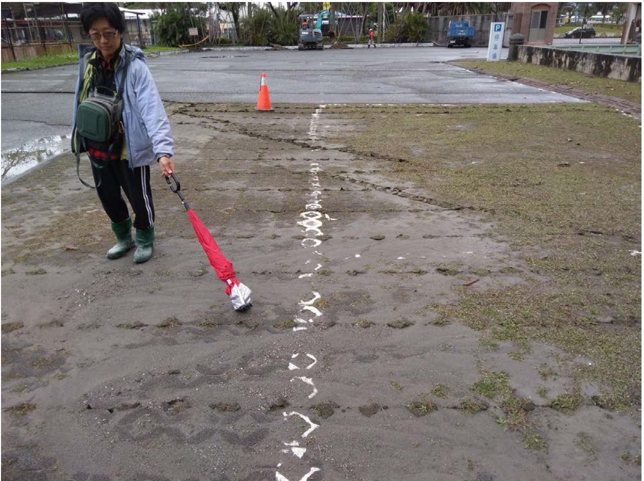
圖 2-1-1-17、上述地表破裂繞體育館造成破裂與噴砂，向西南拍攝。劉彥求攝。
