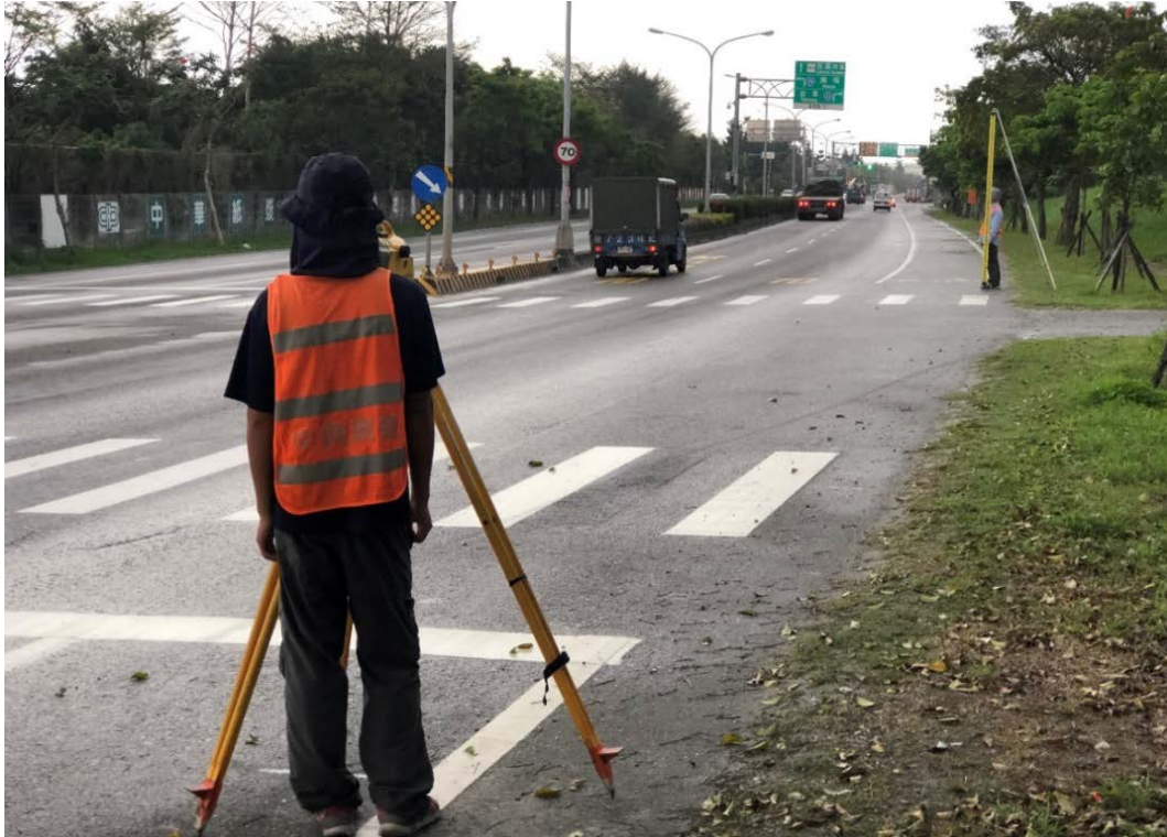
圖 3-4-2、本次地震後水準測量施測情形。觀測時以電子水準儀及鈹鋼尺施測，利用逐站觀測前、後視標尺求得高程差方式，累積得到二水準點間的總高程差，觀測精度符合一等水準作業規範的要求。許晉瑋攝。
