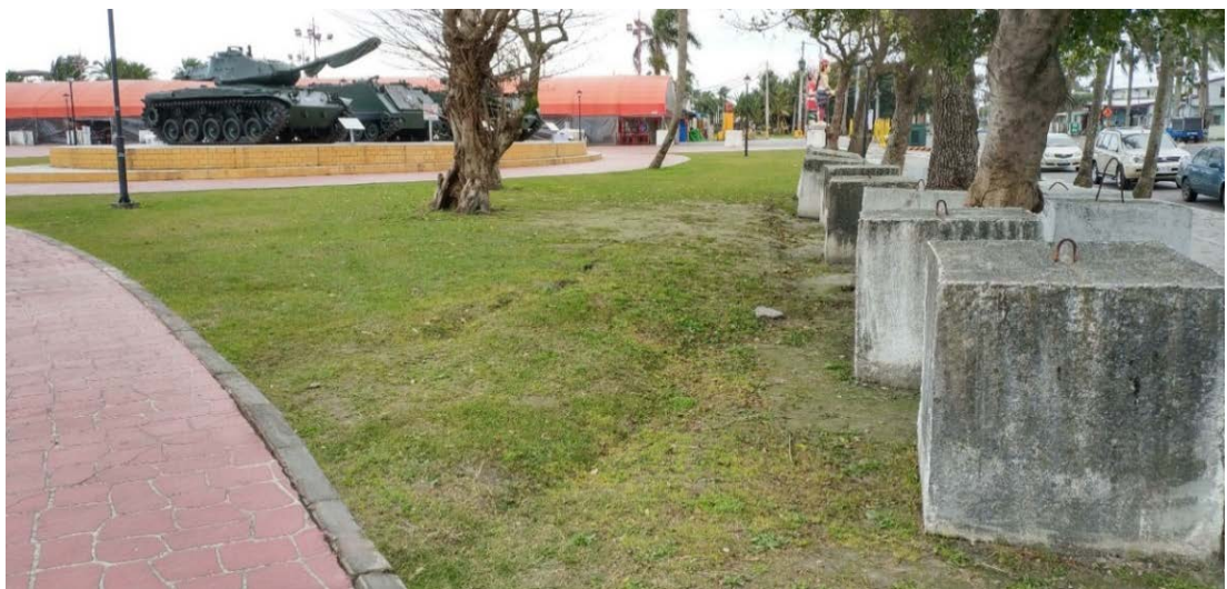
圖 2-1-2-28、自由路東大夜市門口右側草皮地表變形，圖上草皮東側隆升約 15 公分，以 N20^{\circ}W 方向朝花蓮代天府延伸。黃志遠攝。
